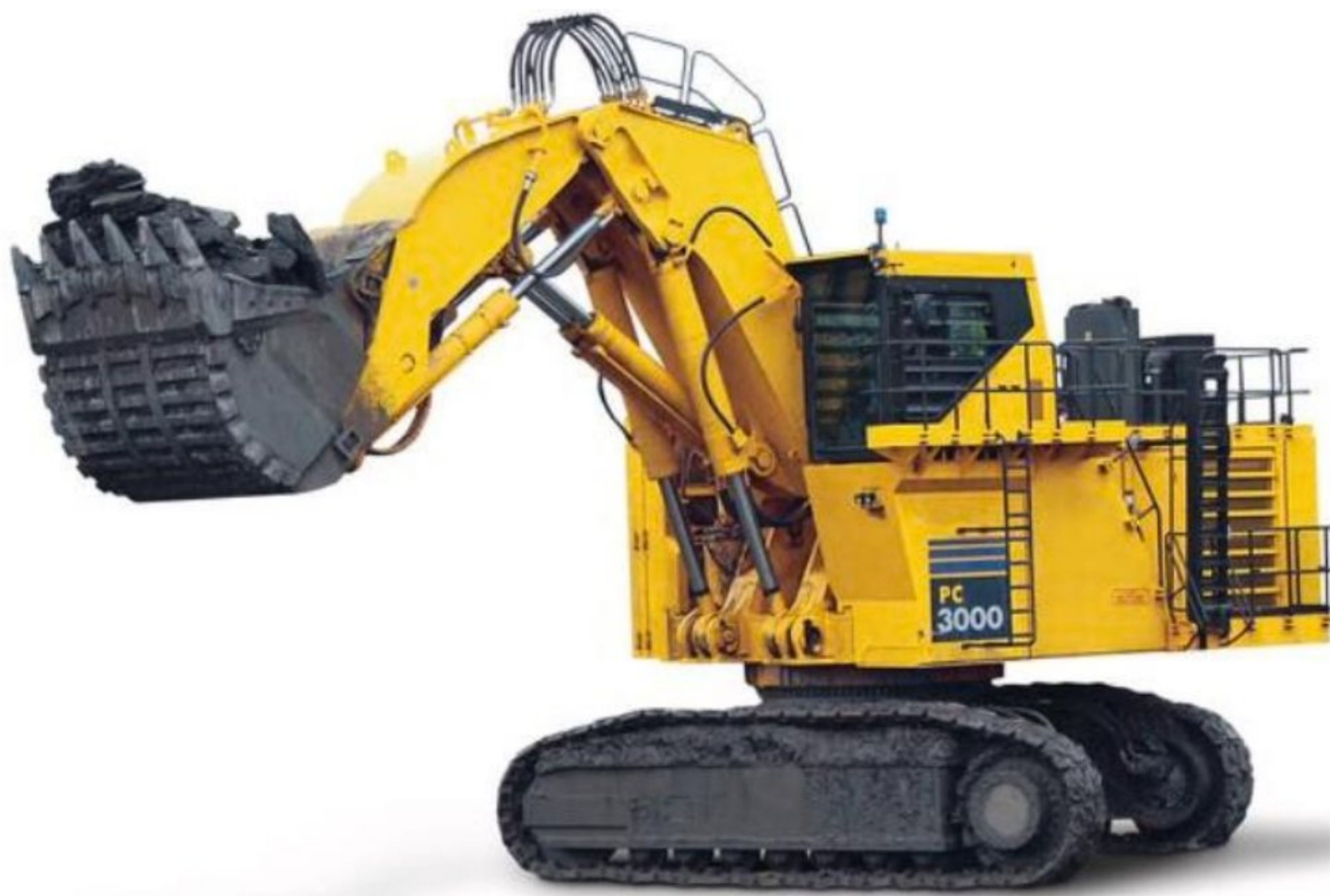
Slika 5.1: Bager Komatsu PC3000 sa osnovnim parametrima (www.komatsu.com)
