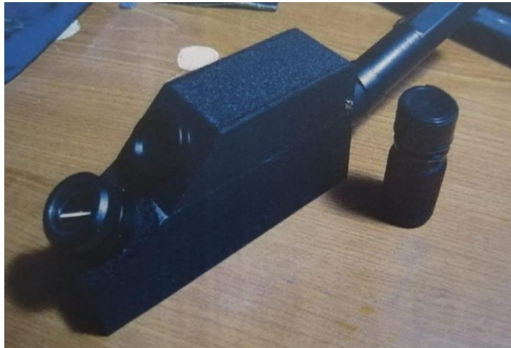
Slika 14. Refraktometar CL-181 na kojem su izvršena ispitivanja.
