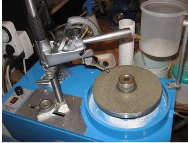
Slika 17. Mašina na kojoj je izvršeno brušenje i poliranje ravnih površina juvelirskih mineralnih sirovina
