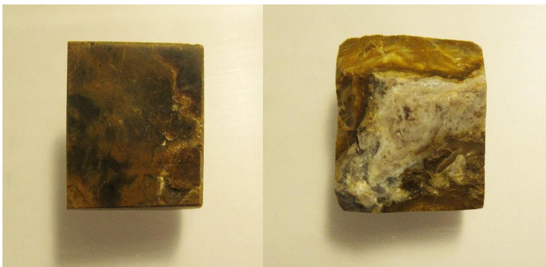
Slika 9. Uzorak LP-2, dimenzije 23x 18 mm (levo – donji ispolirani deo i desno gornji netretirani deo uzorka)
