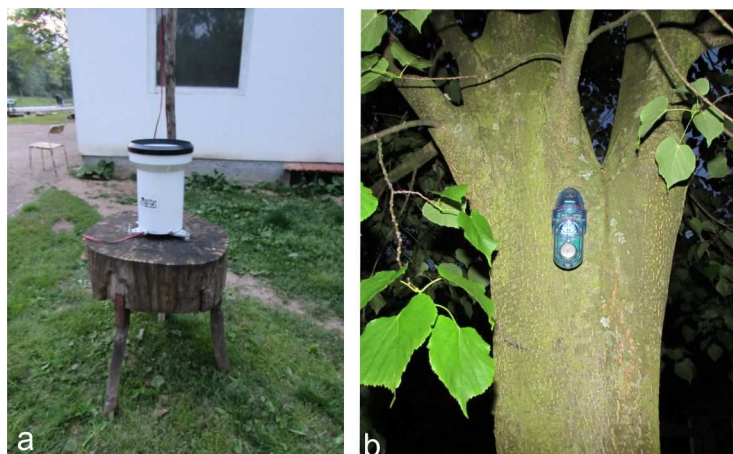
Slika 5.33. a) Digitalni kišomer sa logerom ( Delta Ohm , Italija). b) Digitalni loger temperature ( MicroLite ) sa autonomijom baterije do dve godine uz mogućnost memorisanja 32 000 podataka
