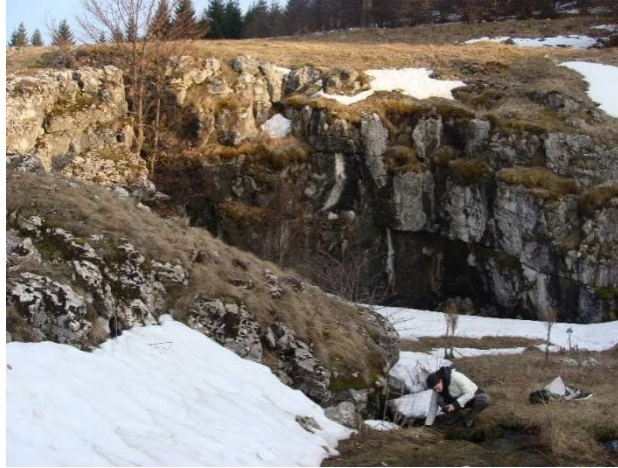
Slika 4.16. Uzorkovanje vode u ponorskoj zoni koja je aktivna u periodu malih voda; u pozadini krečnjački odsek u podnožju kojeg se nalazi ponor Busovate (foto: S.
