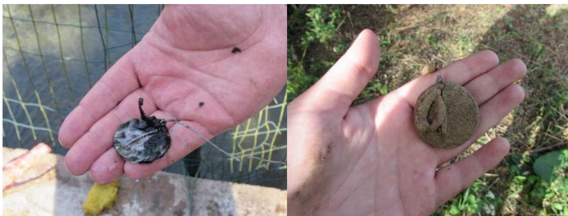
Slike 5.41 i 5.42. Pločice nakon 18 meseci (levo: termalni izvor na Krupaji; desno: naslage mladog bigra na Malom vrelu)
