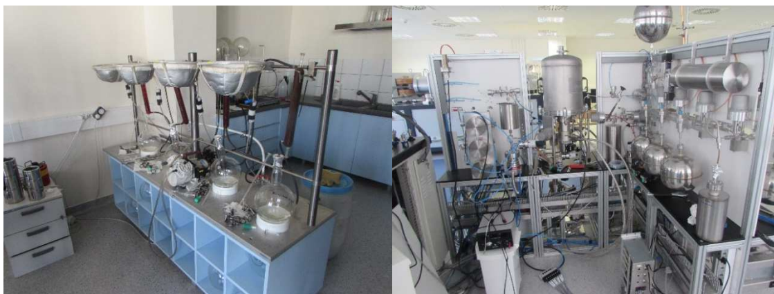
Slika 5.30. a) Priprema uzorka za analiziranje sadržaja tricijuma i T+^3\text{He} ; b) uređaj VG5400 noble gas mass spectrometer za analiziranje sadržaja tricijuma i T+^3\text{He}
