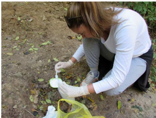
Slika 5.23. Dodavanje \text{BaCl}_2 u bočicu sa uzorkom vode (foto: S. Milanović)
