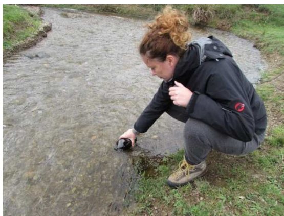
Slika 5.28. Uzorkovanje vode za analizu tricijuma (foto: S. Milanović)
