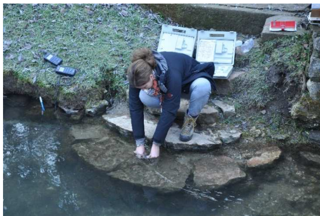
Slika 5.22. Zahvatanje vode i zatvaranje boce pod vodom (foto: M. Kličković)
