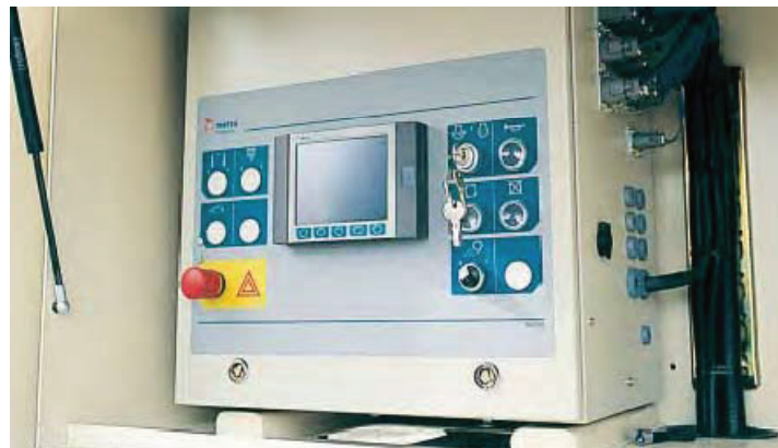
Слика број 3.12 Централни дисплеј дробилице „Lokotrack LT 1213S“
