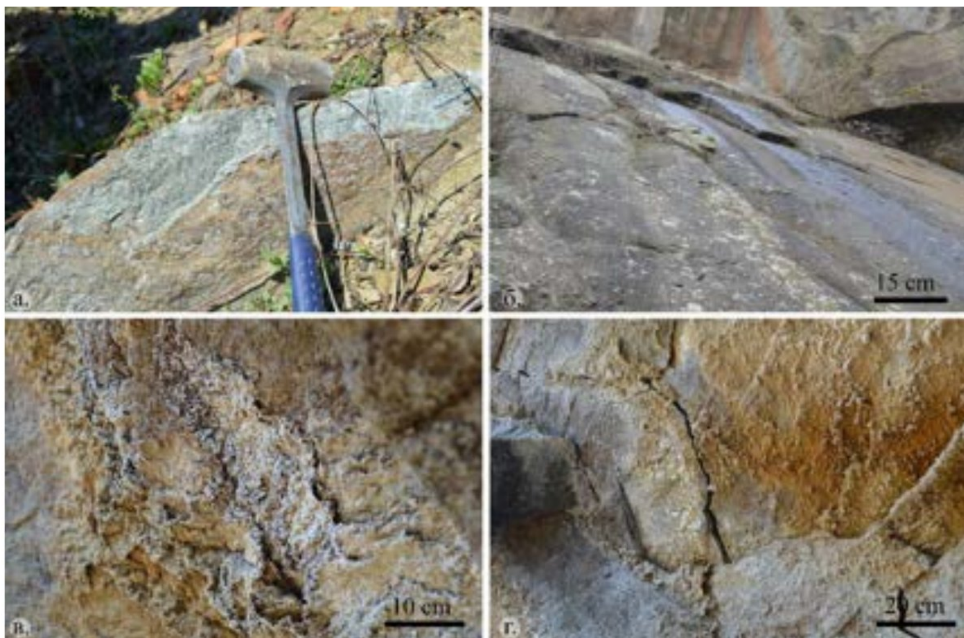
Слика 31. Декolorација/наслаге: а) површинска декolorација и боја свеже стене; б) биолошка колонизација (лишјајеви, маховине и више коренасте биљке; в) наслаге соли и светле коре са појавом одвајања и љуспања – различита дебљина, боја и компактност наслага; г) морфологија депоновања соли – светле, обојене и тамне површине, депоновање у зони пукотина
