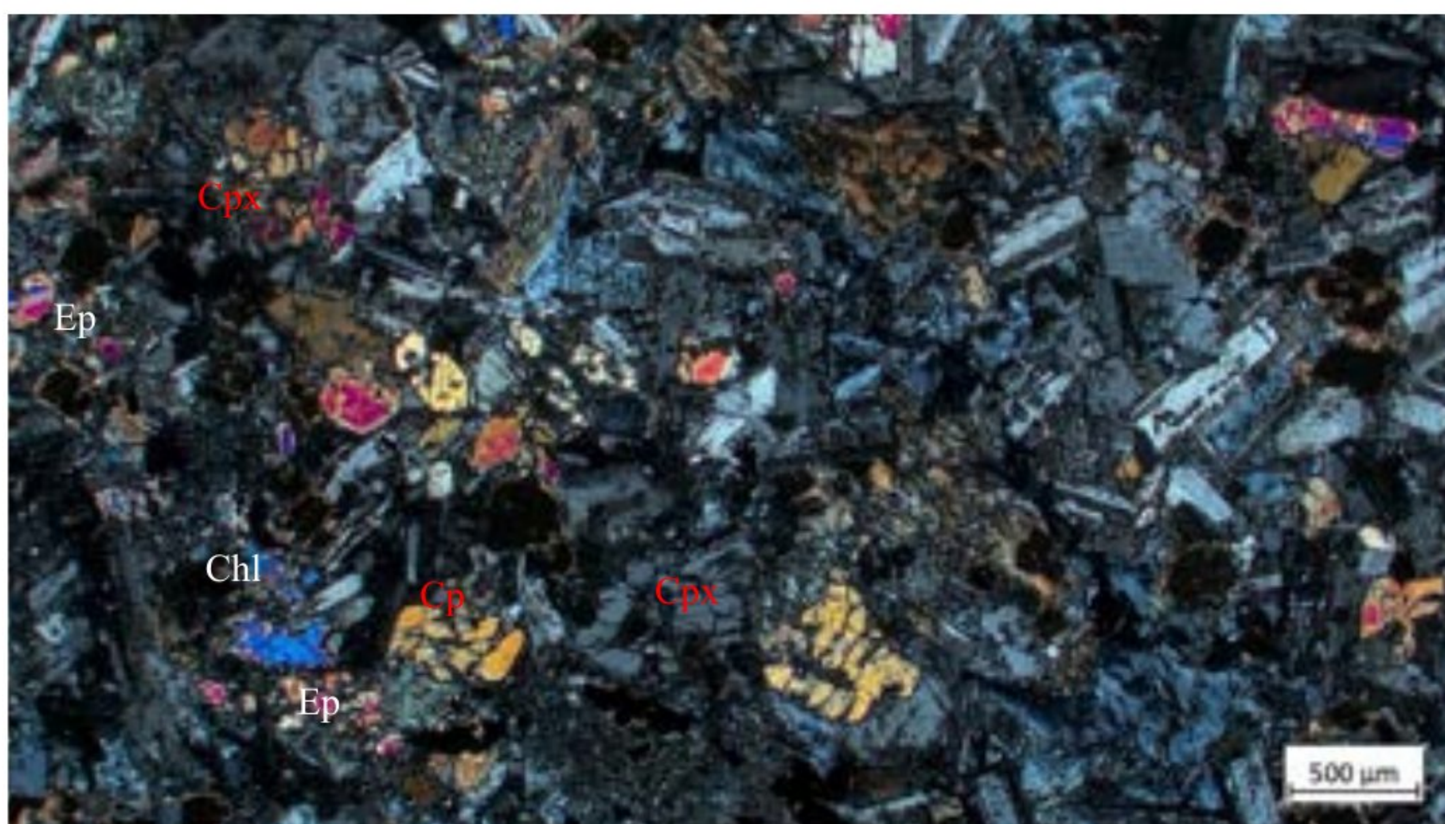
Слика 92. Микрофотографија пироксена, испуцалог, алтерисаног у хлорит и епидот, узорак 1KL, XPL; Легенда ознака: Chl – хлорит; Cp – моноклинични пироксен; Ep – епидот
