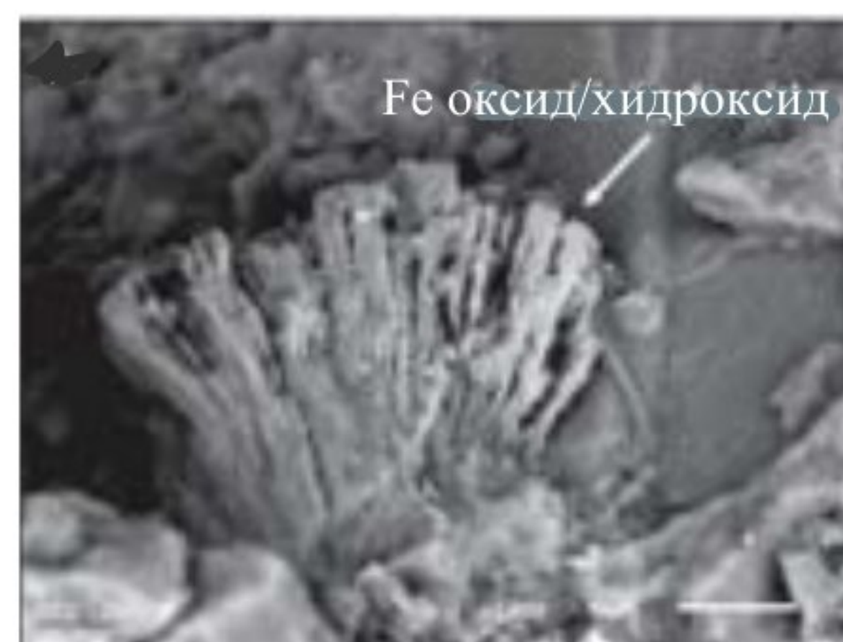
Слика 104. SEM лепезасти агрегат Fe оксида/хидроксида
