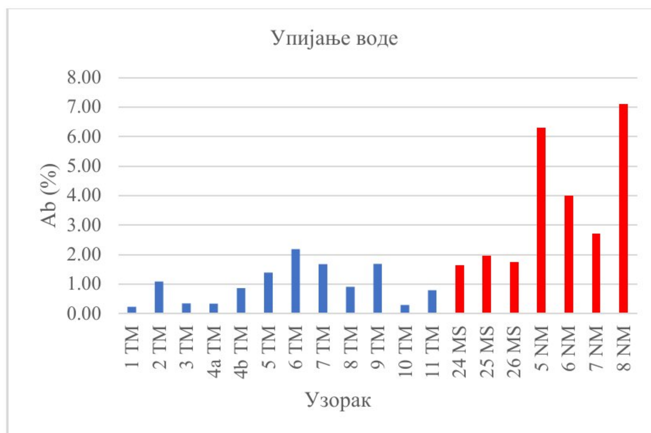
Слика 111. Графички приказ резултата упијања воде (плаво – узорци свеже стене, црвено- алтерисани узорци)
