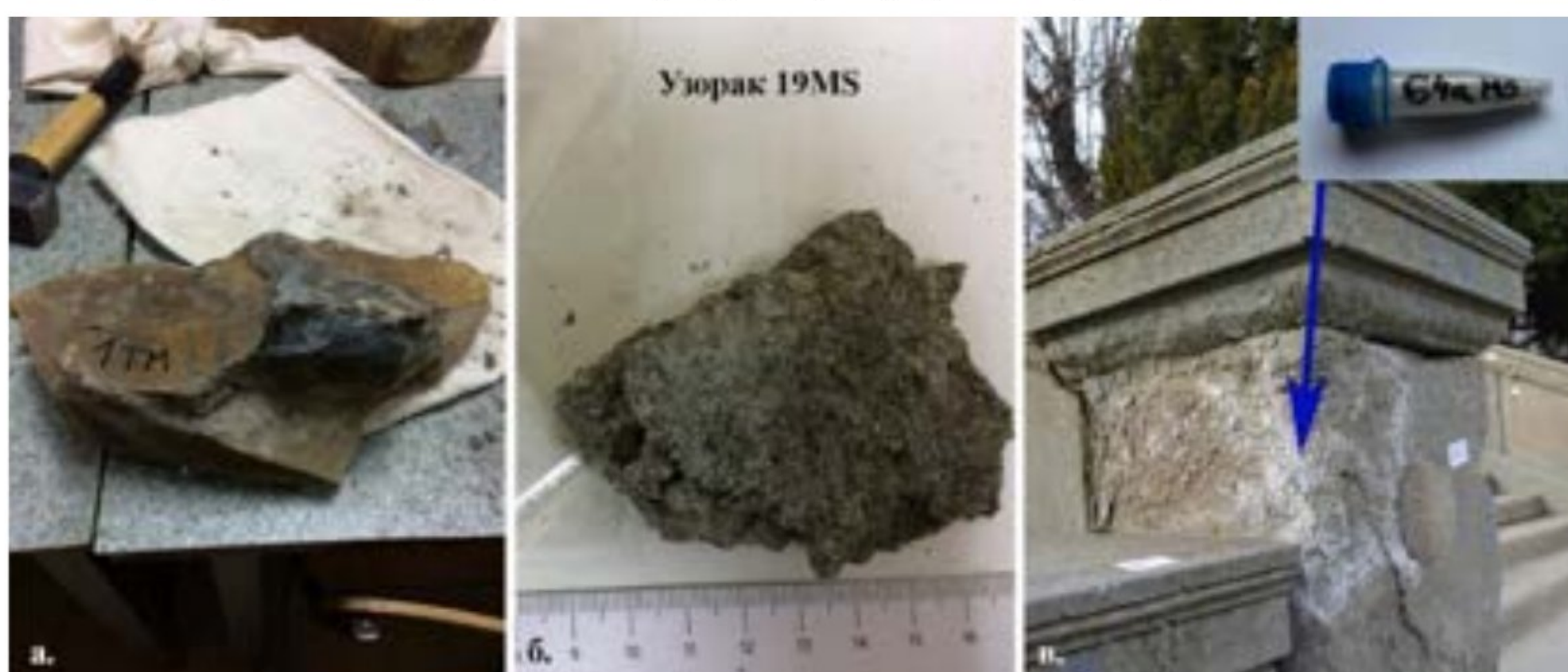
Слика 23. Макроскопски изглед узорака за лабораторијска испитивања; а) узорак керсантита 1TM за оптичка и остала лабораторијска испитивања; б) узорак површинске коре керсантита са Малог степеништа – 19MS; в) узорак соли узет са површине керсантита - 64aMS
