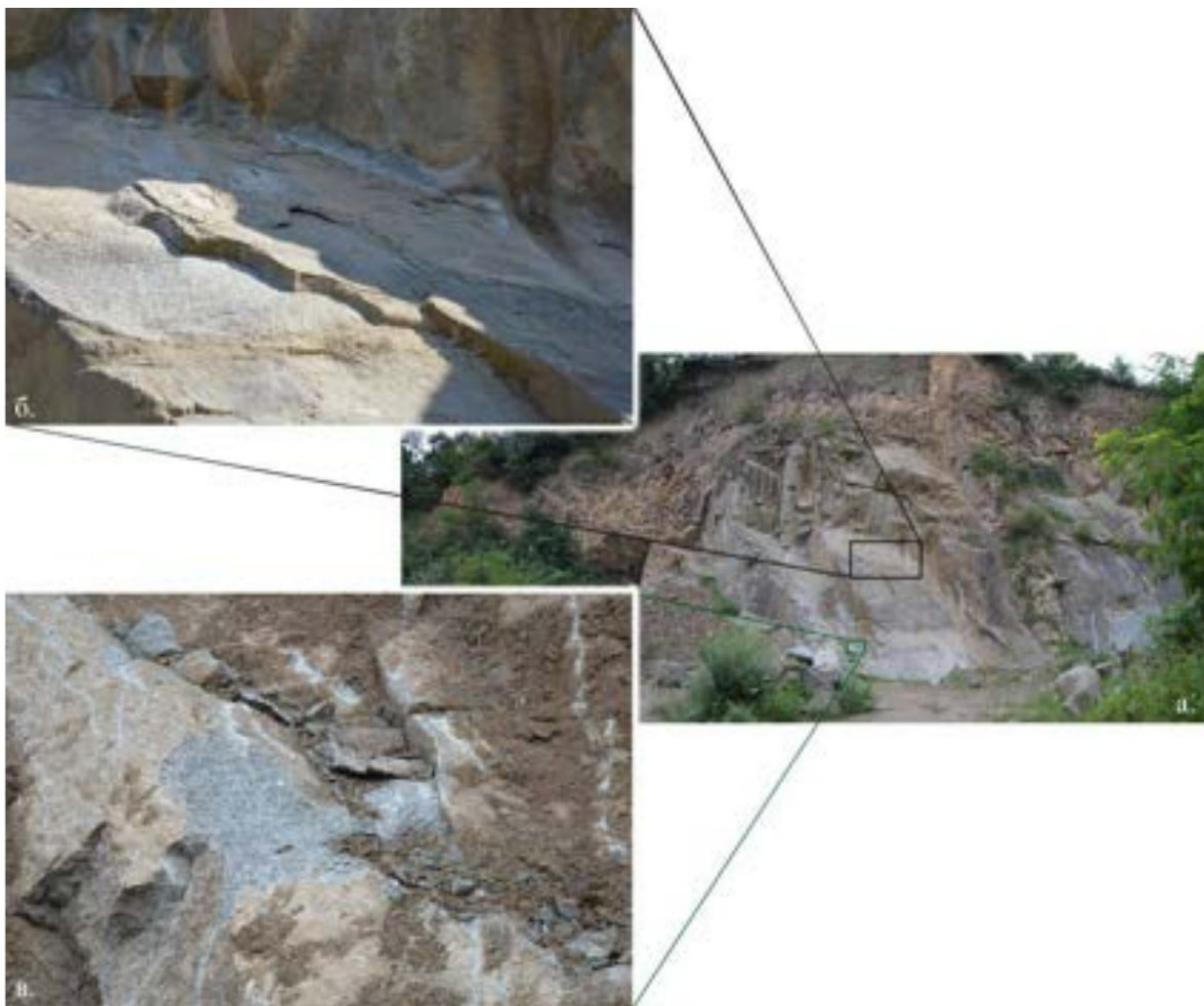
Слика 30. а) Тешића мајдан, оптички изглед са положајем регистрованих форми прве групе распадања; б) губитак каменог материјала; в) иверасто до комадасто распадање
