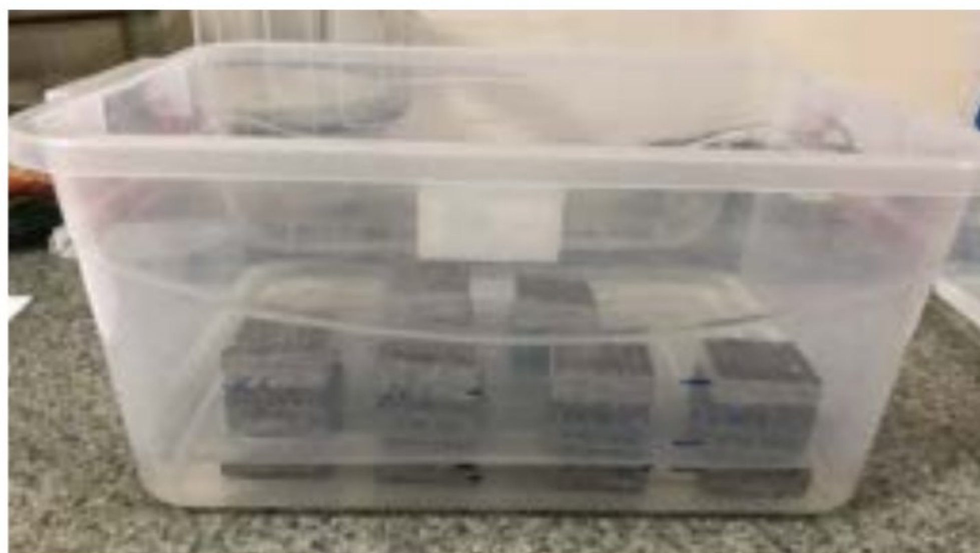
Слика 27. Испитивање упијања воде узорка керсантита
