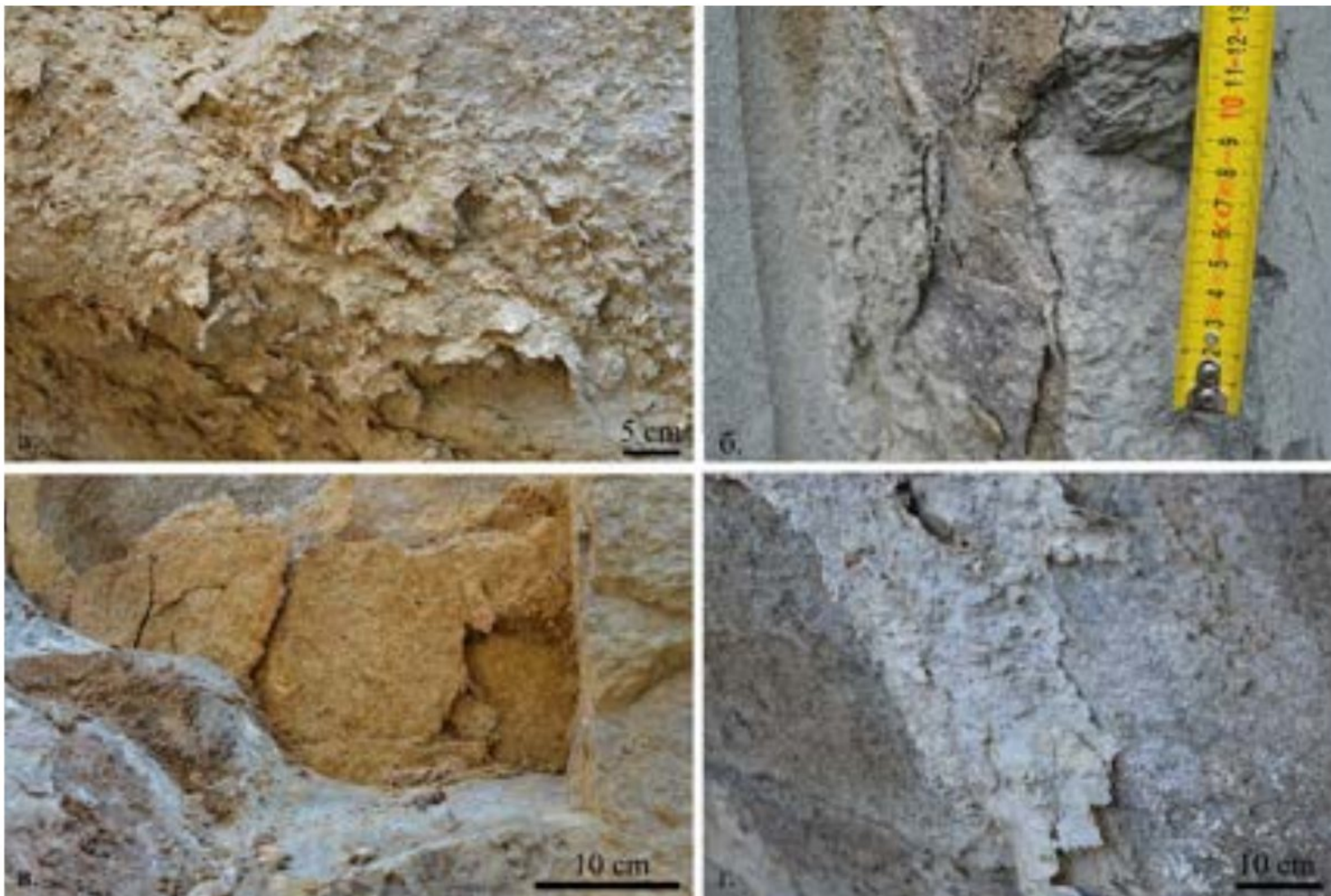
Слика 32. Форме треће групе распадања; а) вишеструко љускање; б) одвајање обојених кора; в) љускање; г) одвајање светлих кора и љускање
