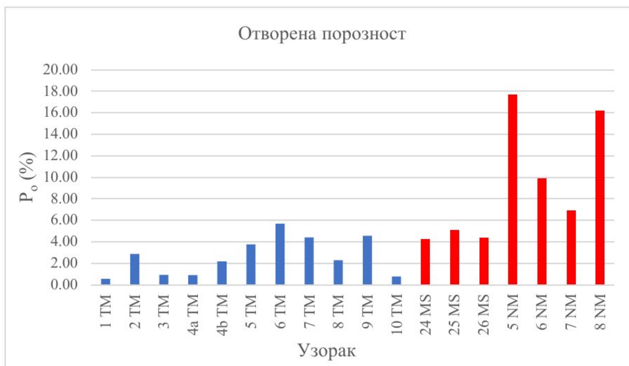
Слика 110. Графички приказ резултата отворене порозности (плаво – узорци свеже стене, црвено-алтерисани узорци)
