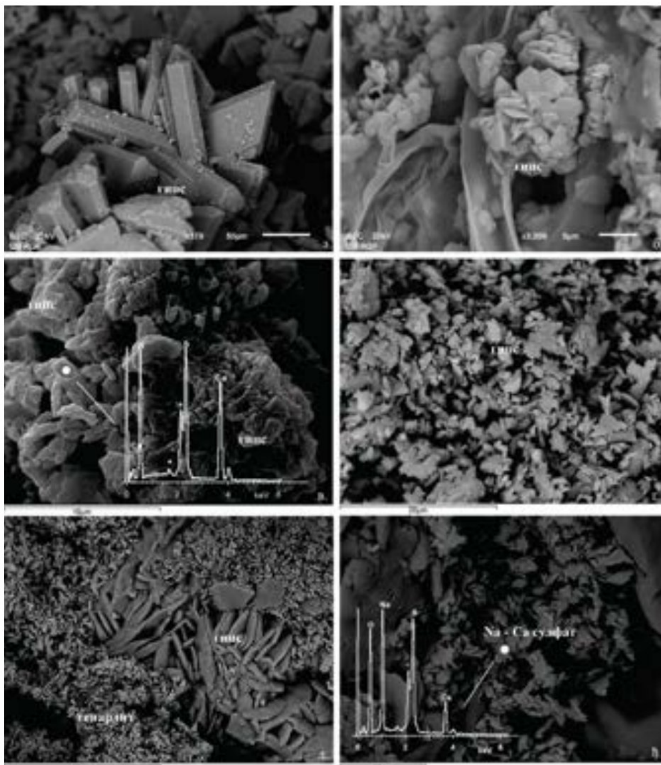
Слика 99. SEM снимци анализираних узорака соли: а) призматични кристали гипса у узорку соли са површине керсантита из каменолома 3sTM; б) агрегат гипса у форми „пустињске руже“ са површине керсантита у каменолому 1sTM; в) гипс у узорку 46MS; г) гипс у узорку 55MS; д) тенардит и гипс (узорак соли 64MS); њ) Na – Ca сулфат у узорку 64MS
