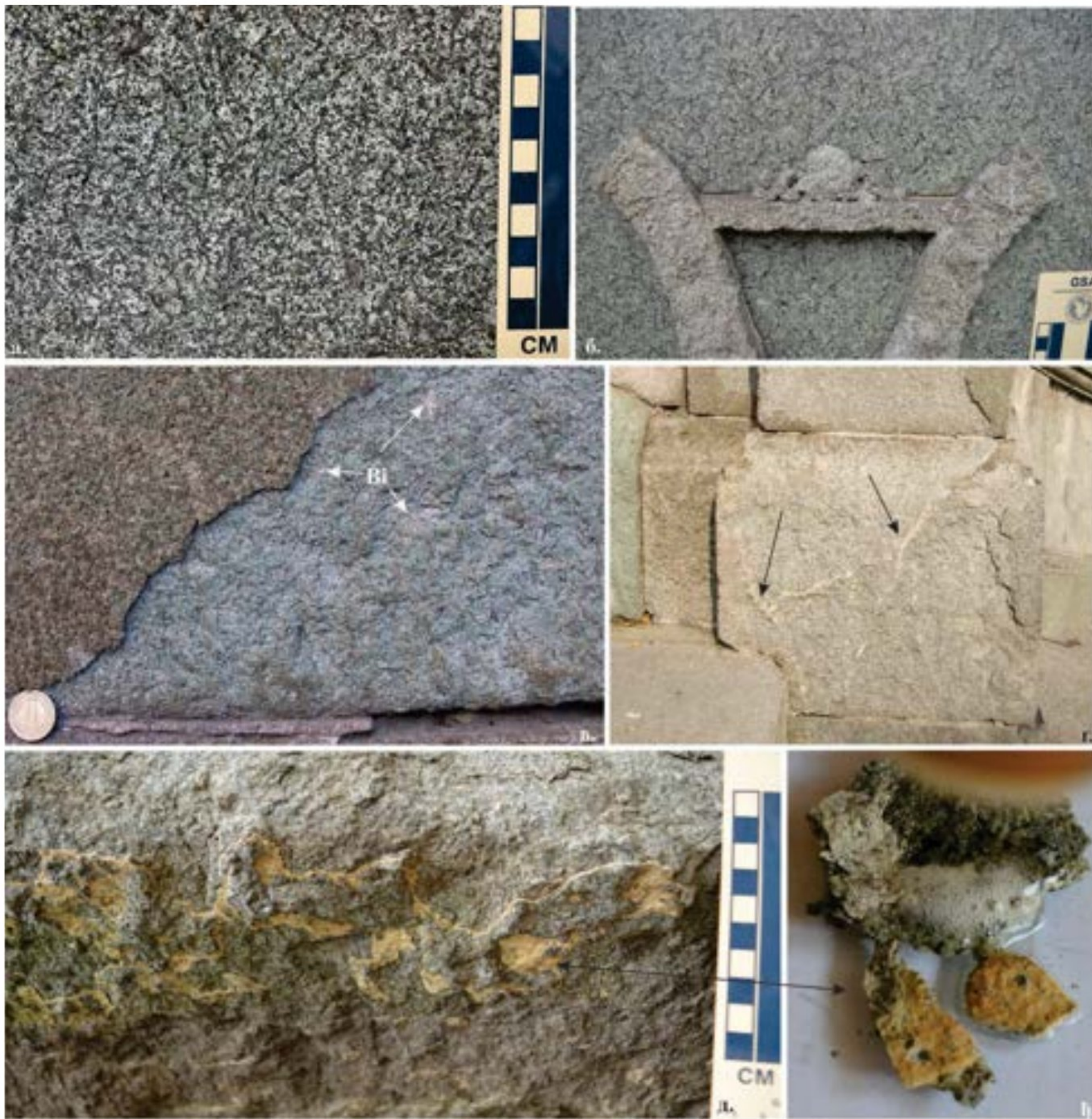
Слика 89. Макроскопски изглед уграђеног керсантита: а) степениште у објекту Класне лутрије; б) офитска структура на полираном керсантиту на споменику Бури Јакшићу; в) гнездаста нагомилања биотита седефасте сјајности на Малом степеништу; г) неокалцитне беле жице видљиве у блоковима Малог степеништа; д) калцит са депонованим оксидима/хидроксидима гвожђа, споменик Јовану Скерлићу; њ) калцит потврђен бурном реакцијом са разблаженном хлороводоничном киселином
