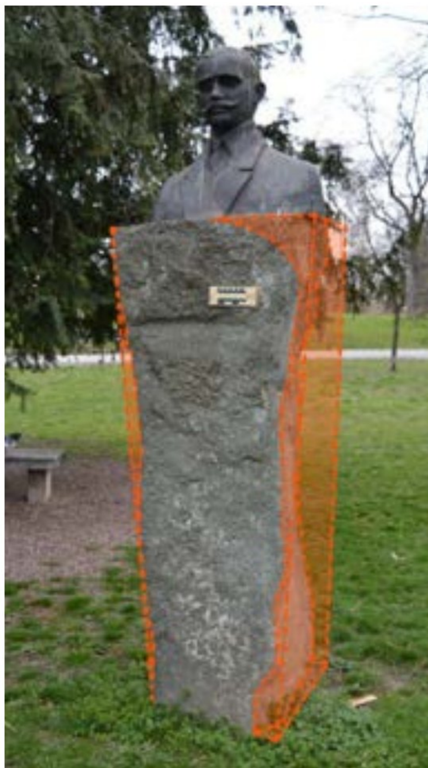
Слика 61. Одступање од оригиналног волумена споменика, укупан губитак материјала (3Д приказ)
