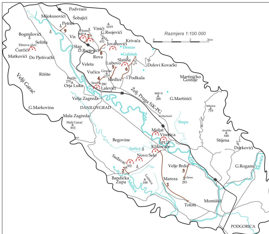
Slika 2.1: Pregledna geografska karta rudnog reona Bjelopavlića sa ucrtanim ležištima arhitektonsko - građevinskog i tehničko - građevinskog kamena i pozicijama snimljenih geoloških stubova
