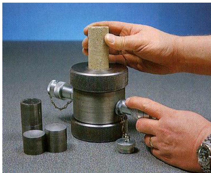
Слика 3.7 - Поступак стављања пробног тела у триаксијалну ћелију [1]
