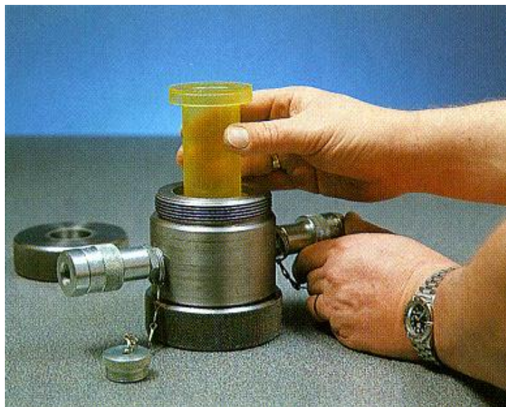
Слика 3.6 - Поступак стављања флексибилне кошуљице у триаксијалну ћелију
