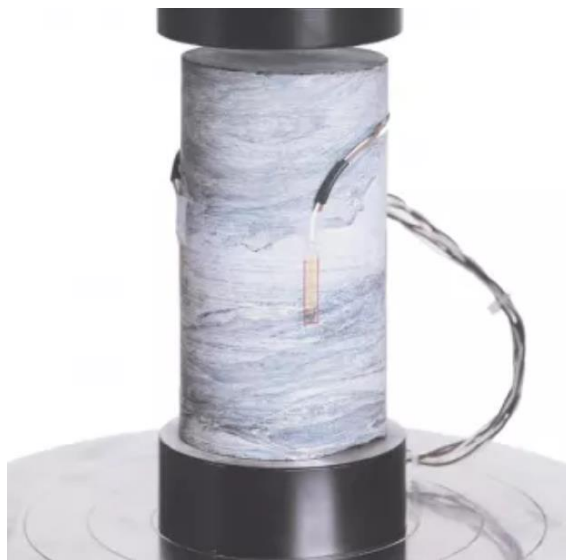
Слика 3.5 - Изглед припремљеног пробног тела са залепљеним електроотпорним мерним тракама [26]
