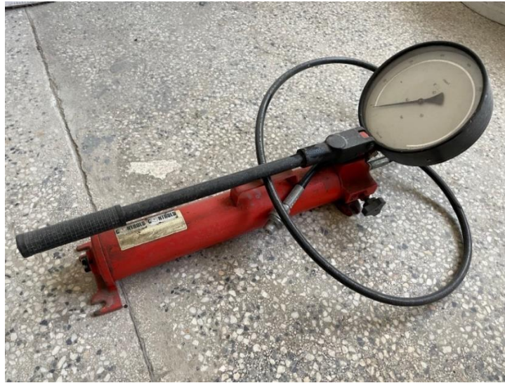
Слика 3.3 - Изглед хидрауличне пумпе за наношење бочног притиска са манометром за праћење притиска
