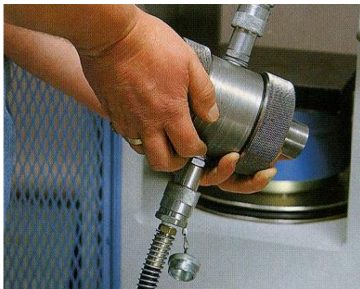
Слика 3.8 - Поступак пуњења триаксијалне ћелије и изглед постављених челичних клипова са додатим малим притиском [1]
