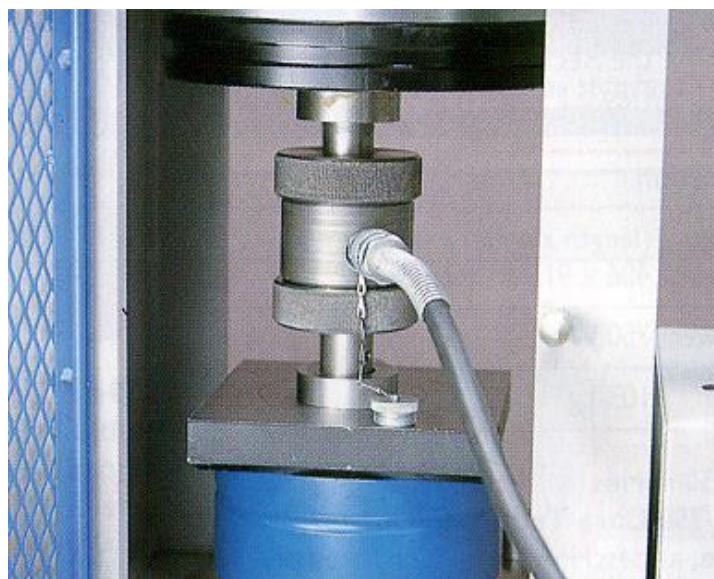
Слика 3.9 - Припремљена триаксијална ћелија стављена под пресу [1]
