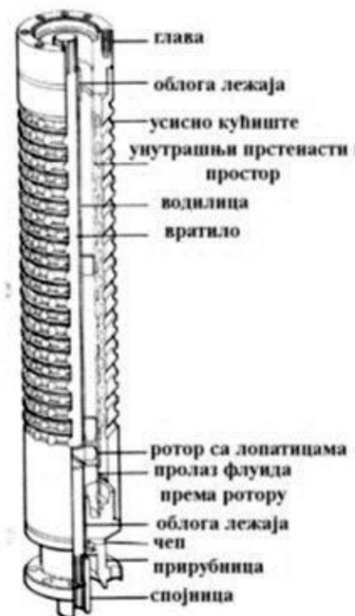
Слика 3.4. Гасни сепаратор (Dr. sc. Marin Čikeš, 2006)
