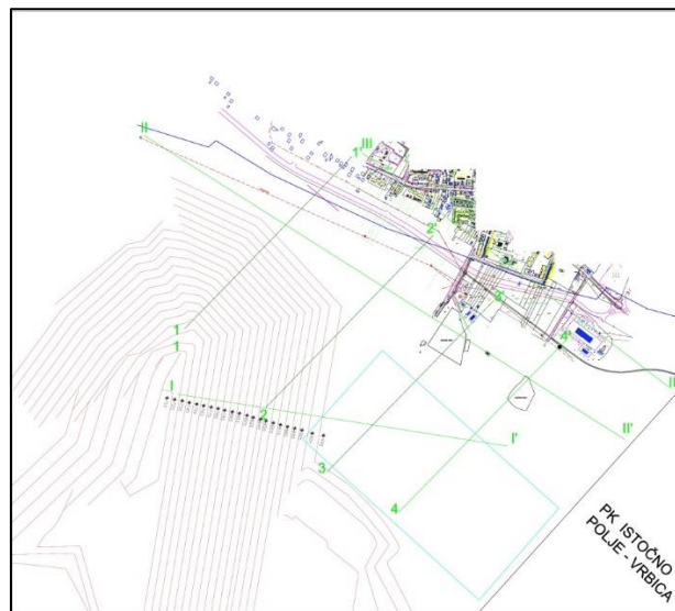
Slika 6. Zoniranje terena sa mogućnošću primene mehanizovanog širokočelnog otkopavanja uglja
