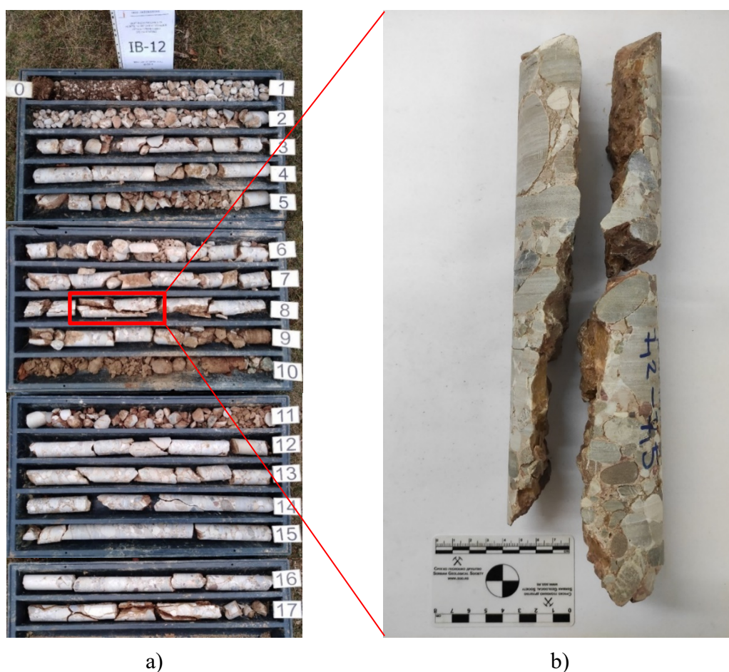
Slika 23. a) Nabušeno jezgro IB-12, b) reprezentativna subvertikalna pukotina (foto: D. Marjanović, 2021 - 2022)
