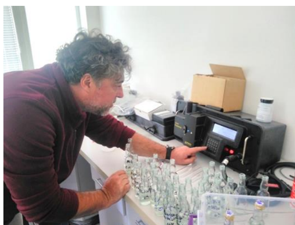
Слика 26. Одређивање концентрације обиљеживача у узорцима на UV флуорметру (Сорајић & Милановић (2018) )
