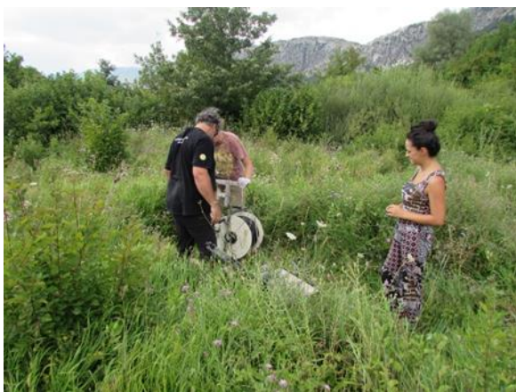
Слика 34. Процес снимања пијезометра (Сорајић & Милановић (2018))
