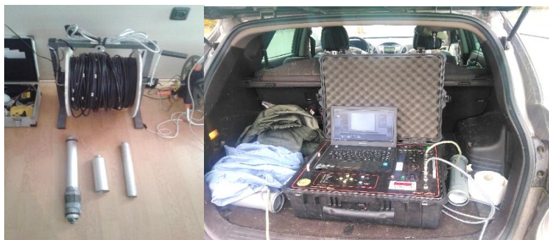
Слика 23. Видеоендоскопски систем за снимање бушотина (С. Милановић, 2018)
