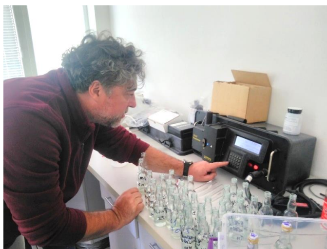
Слика 29. Одређивање концентрације обиљеживача у узорцима на UV флуорметру (С. Милановић, 2018)
