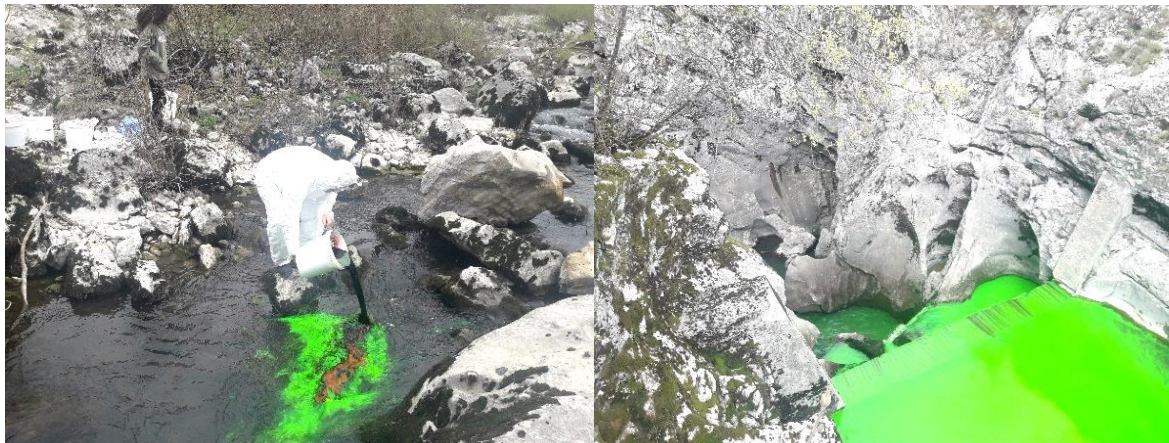
Слика 26. и 27. Процес убацивања обележивача у понор Кључке реке (С. Милановић, 2018)
