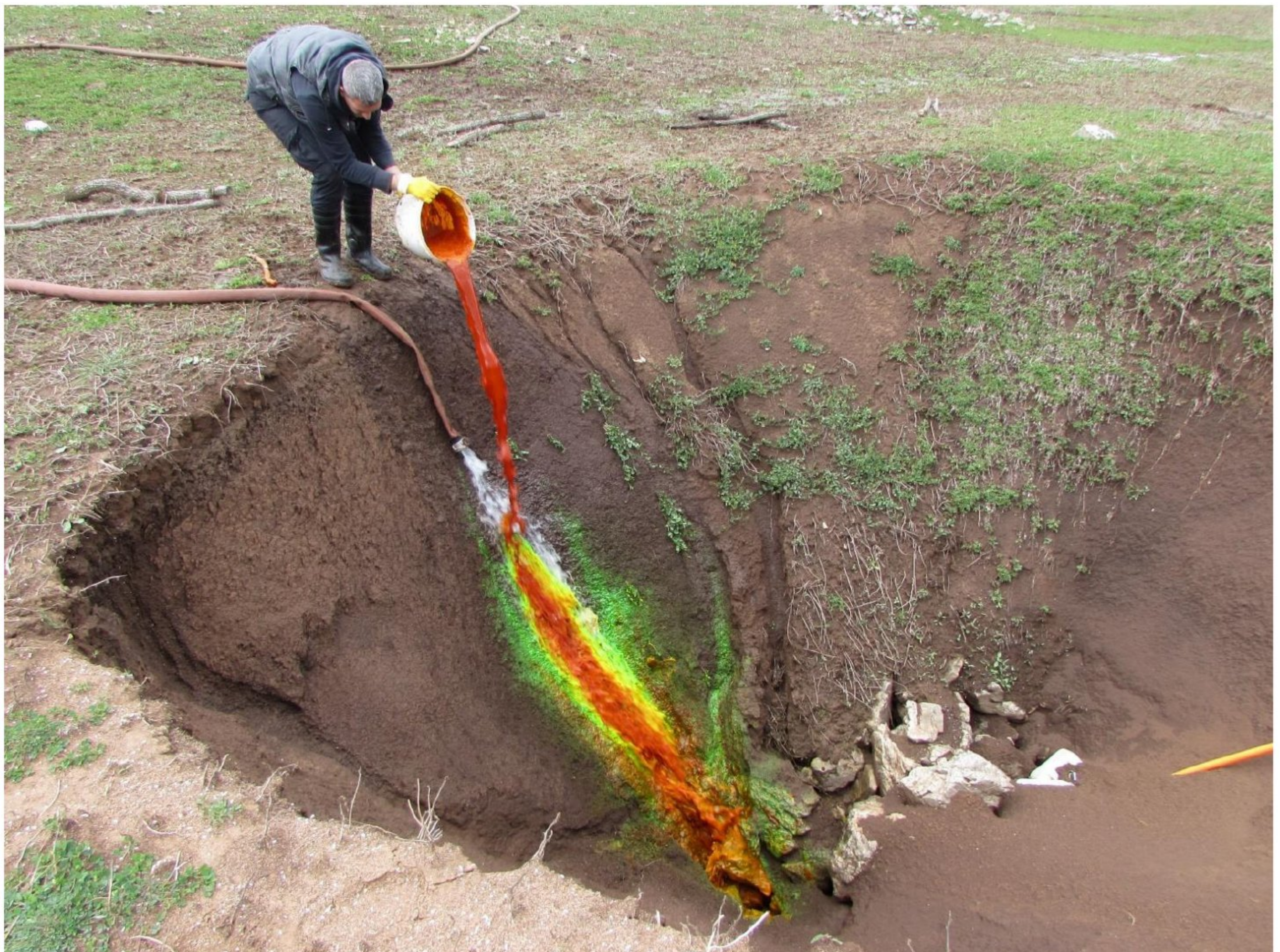
Opit obeležavanja Na-fluoresceinom kolapsa na lokaciji Orah – Bilećka akumulacija Tracer tests with Na-fluoresceine on the Orah collapse location – Bileća reservoir
