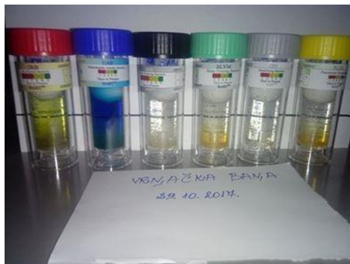
Slika 3.4 Set primenjenih BART biodetektora na primeru mineralnih voda Vranjačke Banje – izvorište „Jezero“*
