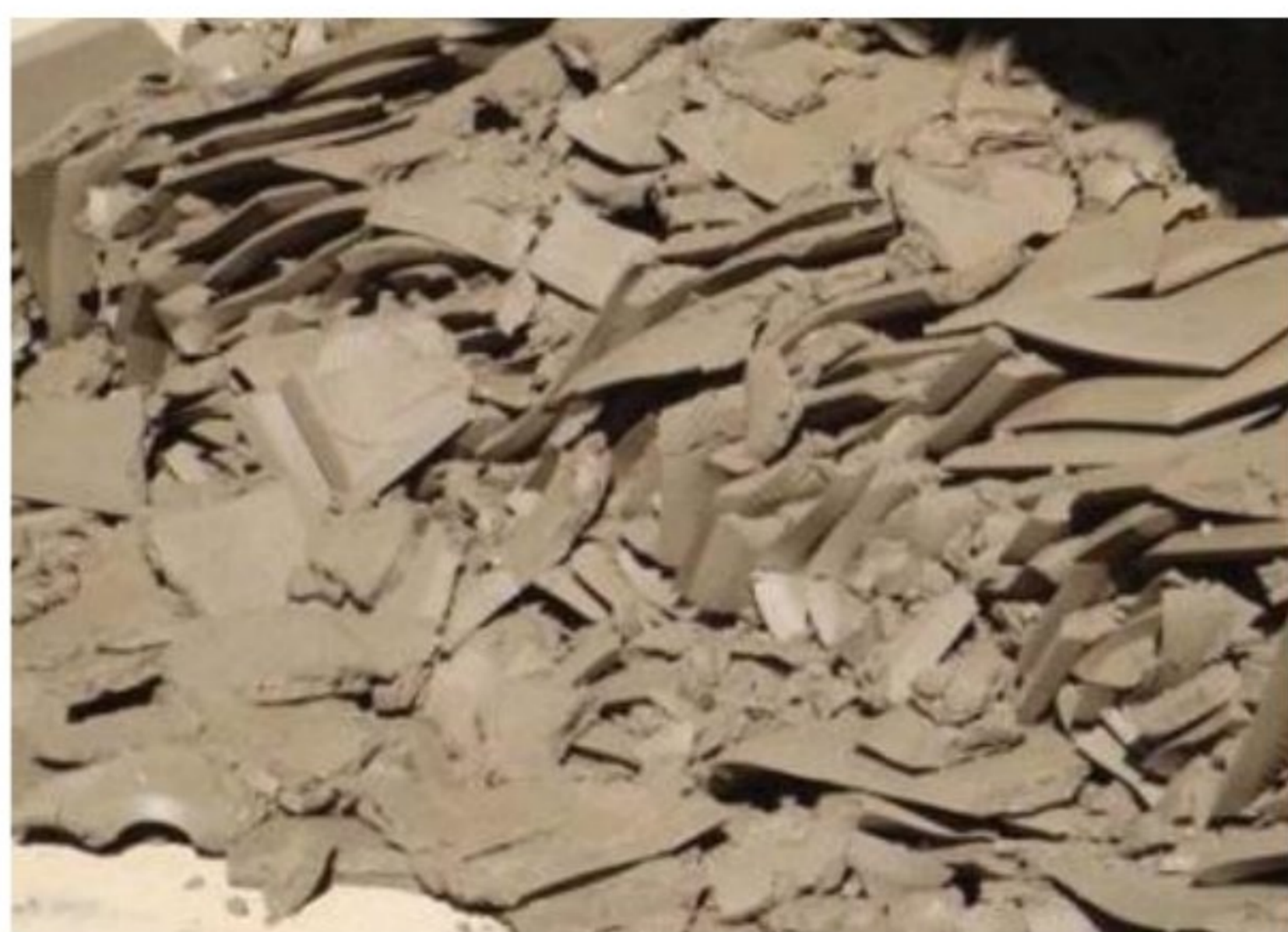
Slika 2. 5 - Deponovanje jalovine u obliku filter keka
