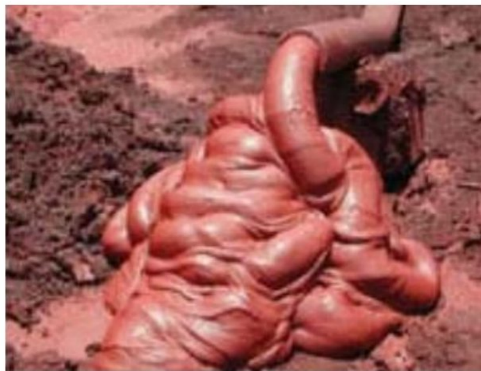
Slika 2. 4 - Deponovanje jalovine u obliku paste
