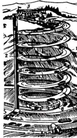
Slika br. 6 Aksonometrijski prikaz spiralne rampe: 1- spiralna rampa, 2- okno, 3- istovarna stanica
