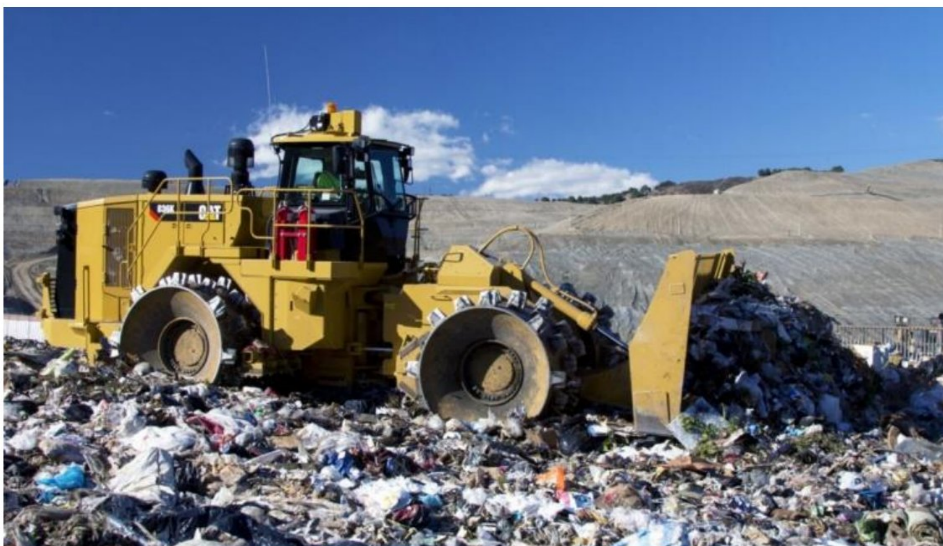
Slika 2.1: Kompaktor za razastiranje i zbijanje komunalnog otpada ( www.hawthornecat.com )
