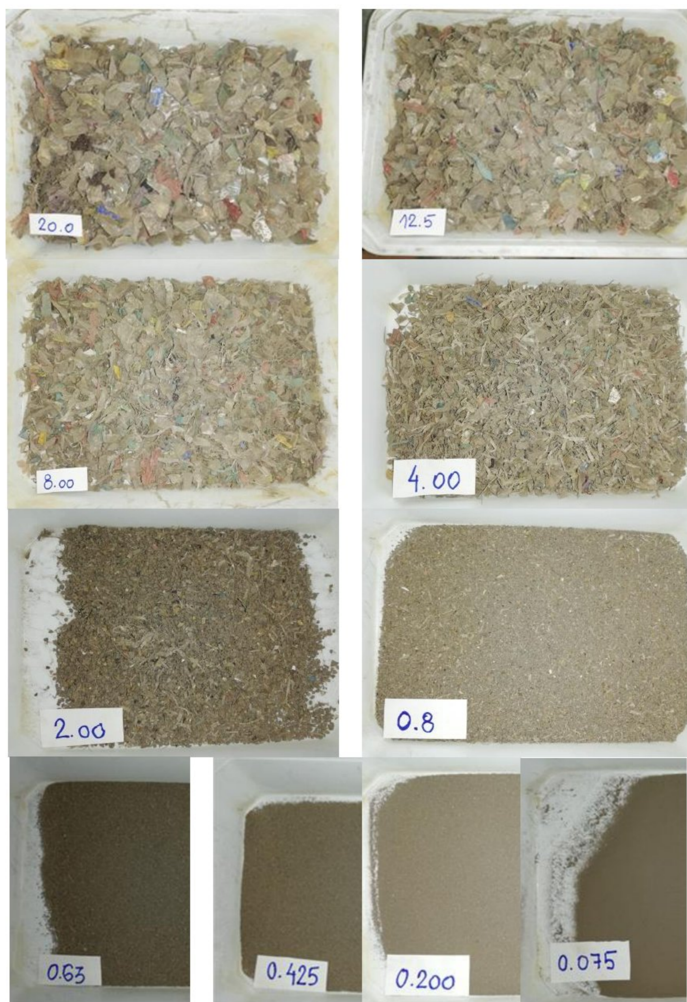
Slika 5.5: Ostatak komunalnog otpada na sitima različitih veličina otvora (mm) za uzorak U-3
