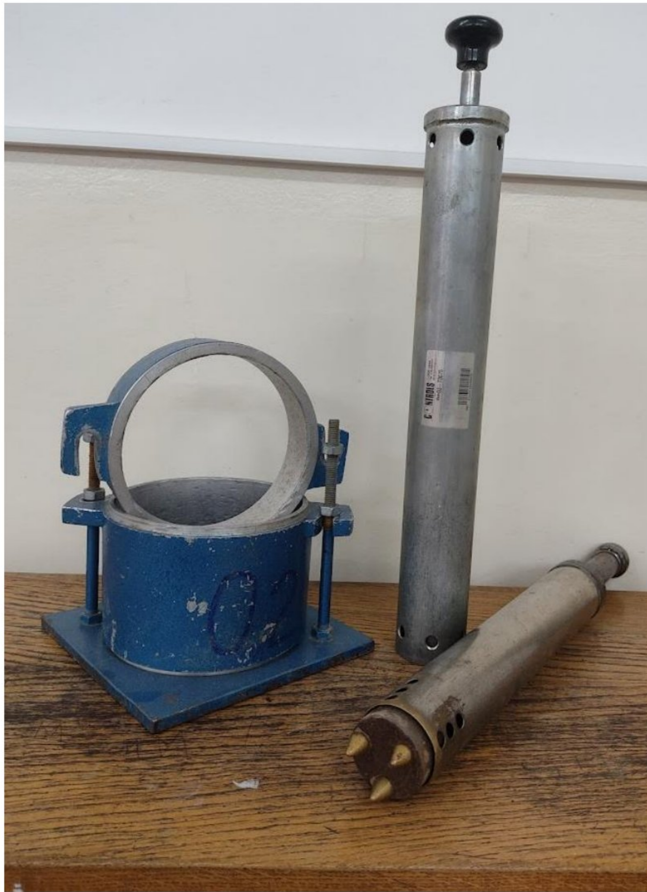
Slika 3.4: Oprema korišćena za izvođenje Proktorovog opita (Proktorov kalup, klasičan i malj sa šiljcima)
