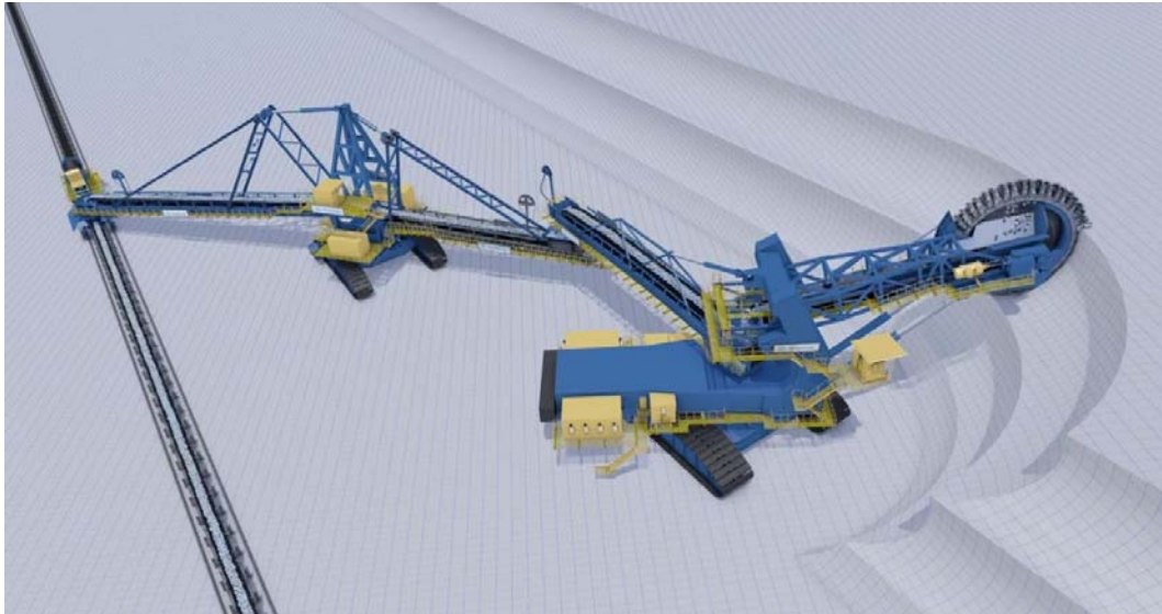
Slika 3.16 Kontinualni sistem Baracuda (Thyssenkrupp, 2017)
