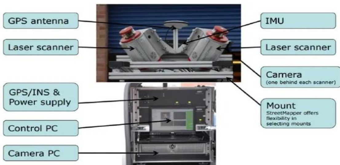
Слика 2. Изглед опреме која се монтира на возило.
