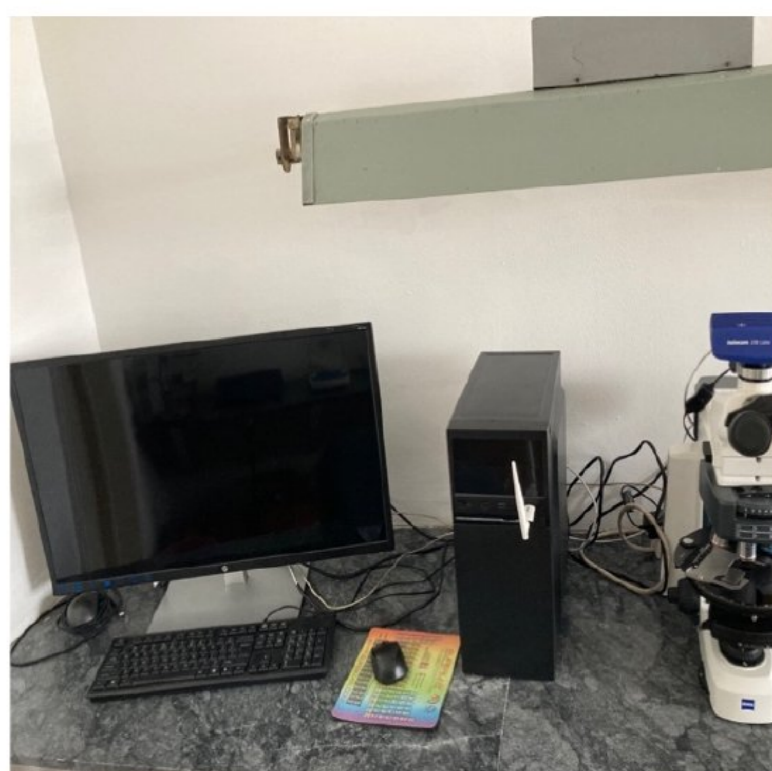
Slika 4. Mikroskop Axioscope 5 proizvođača ZEISS koji je povezan sa kamerom „Axiocam 208 color”
